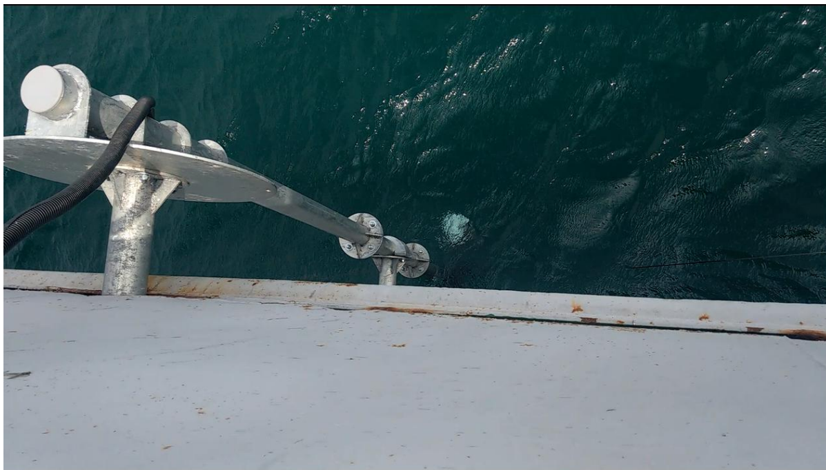
Рисунок 1. Штанга забортного устройства с многолучевым эхолотом в рабочем положении
